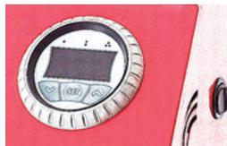
Mantenha a tecla SET pressionada e as teclas < ou > para aumentar ou diminuir o set point ( temperatura de controle).
